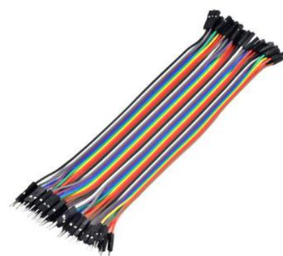
รูปภาพที่ 9 สายไฟจัมเปอร์
